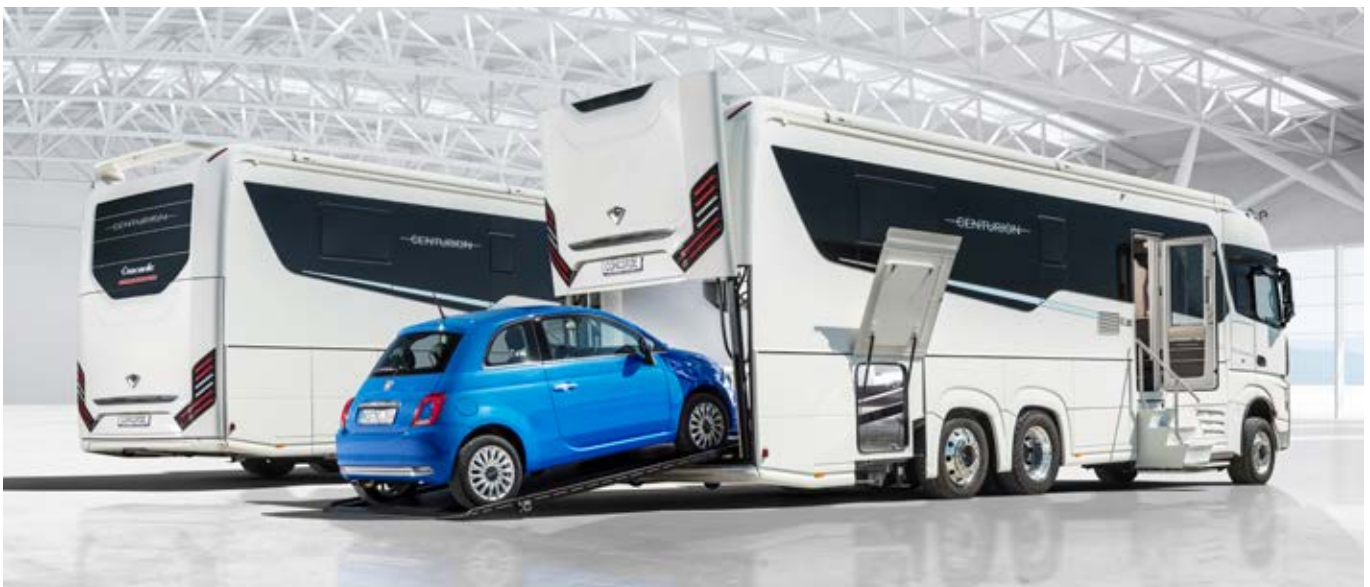
NEUARTIGE PKW-SCHIEBEPLATTFORM DES CENTURION
